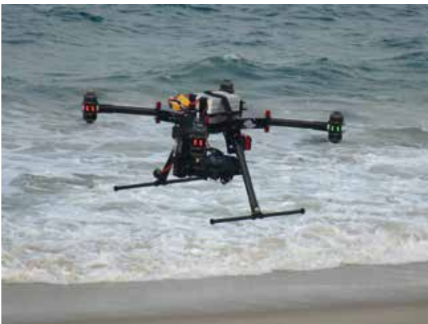
Figuur 1. De octoper (dron met 8 propellers) die gebruikt is om de duinen van Mozambique te fotograferen (zie Fig. 3 blz 39). Bovenop de dron de accu, de camera die onder een hoek gericht staat, zit daar recht onder gemonteerd. Een dergelijke dron is onlangs gebruikt om de kaalgemaakte duinen van Meijendel te fotograferen. Foto: Paul Loth.
