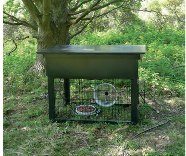
Figuur 1. De meetopstelling in Meijndel. In de deksel van de kooi zitten sensoren en een camera. De tralies zijn zo breed dat ieder dier dat kleiner is dan een rat er gemakkelijk in en uit kan gaan.
