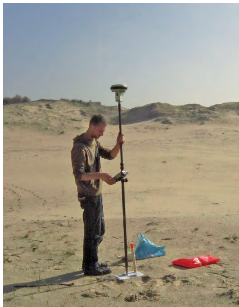
Figuur 2. Camiel Aarts (Dunea) meet de preciese positie van een markeringspunt in. Het markeringspunt is terug te zien op de luchtfoto's. Foto Paul Loth.
