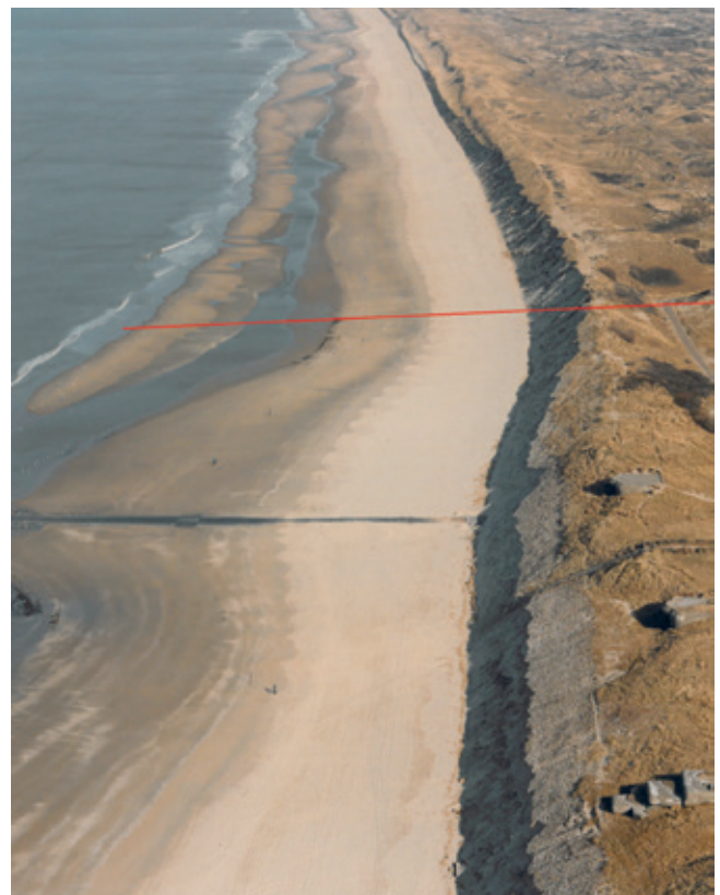
Figuur 1. Luchtfoto van de zeereep ten noorden van Scheveningen na zware storm in februari 1983. De laatste golfbreker van Delfland is te zien. De rode streep geeft de gemeentel- en waterschapsgrens aan.
